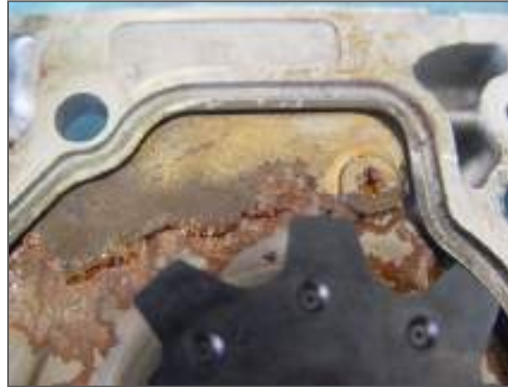
Corrosión de Placa Inferior
