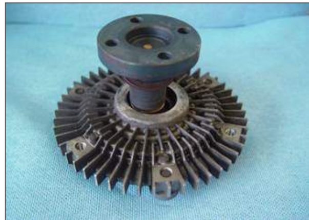
Rodamiento del Fan Clutch bloqueado → rotura
