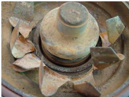
Corrosión del impulsor
